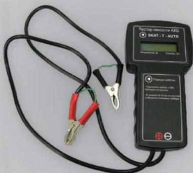
АВТОматический тестер контроля емкости АКБ 12 В, ёмкостью от 1,2 до 120 Ач. Оценка и цифровая индикация фактической емкости АКБ. Быстрая оценка емкости АКБ (около 15 сек), не требует калибровки или выбора диапазона измерений, цифровой АВТОматический тестер контроля емкости АКБ 12 В, ёмкостью от 1,2 до 120 Ач. Оценка и цифровая индикация фактической емкости АКБ. Быстрая оценка емкости АКБ (около 15 сек), не требует калибровки или выбора диапазона измерений, цифровой дисплей.
