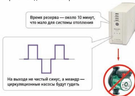
Обычный компьютерный UPS, работающий от АКБ 7—12 Ач никогда не обеспечит многочасовое время резервирования тепловой системы (в то время, как наши источники способны заряжать аккумуляторы до 200 Ач и более!), к тому же его использование затруднено из-за известных проблем фазировки, когда розжиг котла просто не включается.
