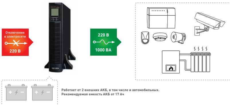
Изделие представляет собой современный экономичный источник бесперебойного питания с функциями защиты и контроля и обеспечивает подключенные к его выходу устройства длительным, стабилизированным электропитанием при отсутствии напряжения сети, используя при этом электроэнергию, запасенную в аккумуляторных батареях.
