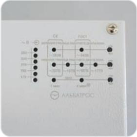
Устройство защиты всего дома / квартиры 220 В, 12 кВт от кратковременных и длительных перенапряжений до 500 В, вызванных наводками в результате воздействия электромагнитных импульсов (грозовые разряды, коммутационные помехи и др.) и авариями в сети.
