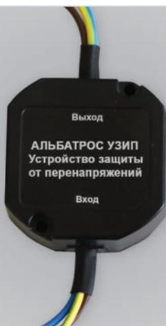
АЛЬБАТРОС УЗИП 220/1000 АС является прибором III класса, ограничивающего типа и предназначено для защиты потребителей от остаточных бросков напряжений, защиты от дифференциальных (несимметричных) перенапряжений и отвода импульсов тока в однофазной сети, связанных с внешними воздействиями.
